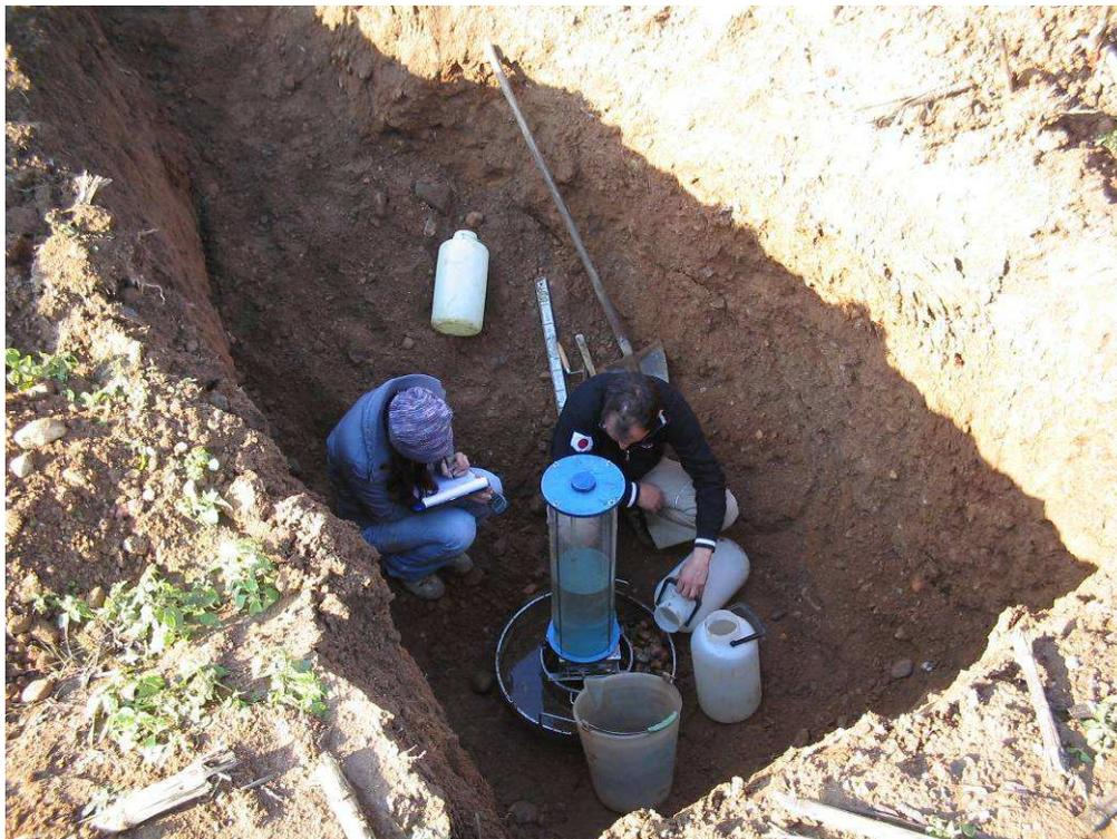
Foto 3 – Esecuzione di una prova infiltrometrica in pozzetto
