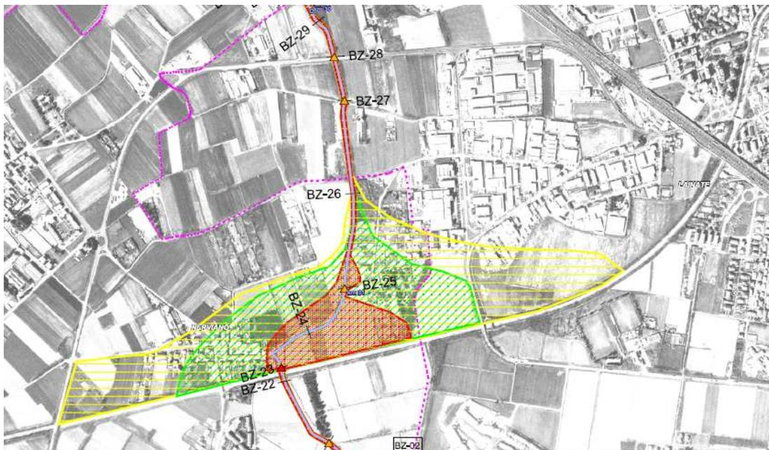
Figura 21 – Aree di esondazione del Bozzente in Nerviano, a monte del Canale Villoresi [1]
